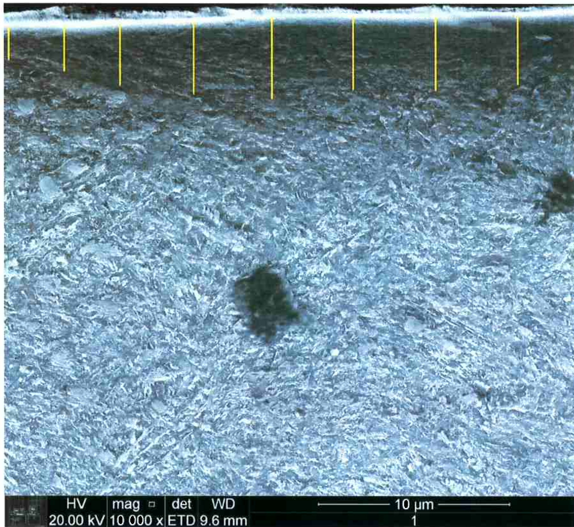
Figura 18: Imagem com 10000x de aumento da seção transversal do pino ensaiado com adição de Cu 20µm em destaque sua camada deformada. SEI-MEV.
